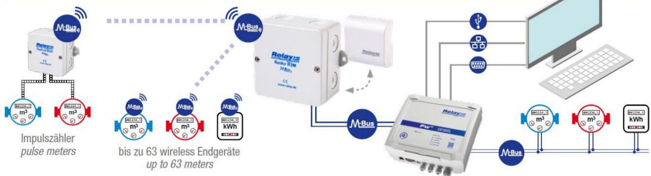
Bilde: Trådløst M-Bus-system med PadPuls M2W, RelAir R2M Gateway og PW250
