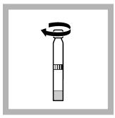
**3.** Screw a grey **DosiCap C** on the cuvette.
